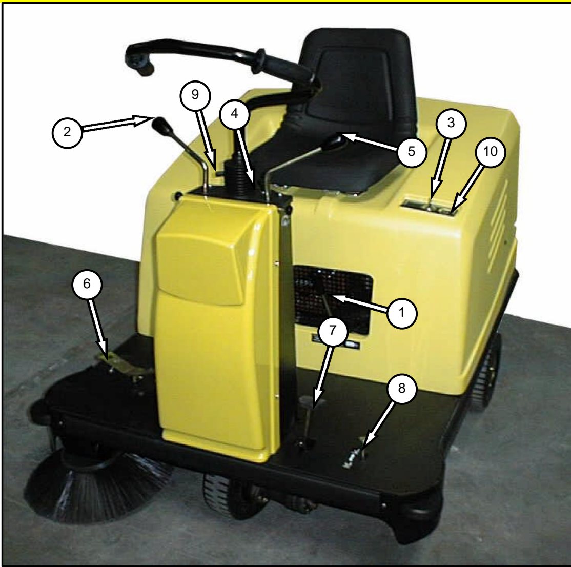
FIG. 3 - APPARECCHI DI CONTROLLO E COMANDI
