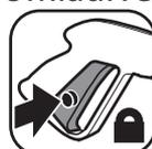
**WARNUNG!** Die Pistole ist mit einer Auslöser-Blockierung ausgerüstet. Betätigen Sie immer,
