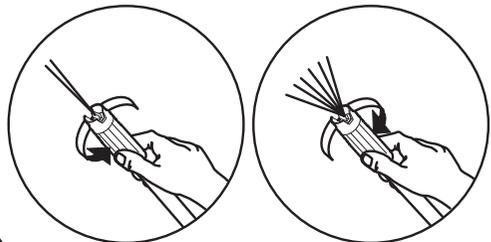
LANCIA TURBO (se presente) • TURBO LANCE (if fitted) • LANCE TURBO (si incluye) • TURBO LANZE (falls vorhanden) • LANZA TURBO (si estuviera presente) • TURBO LANS (indien voorhanden) • MED TURBO-DYSE (hvis der er en) • TURBOLANS (om den finns) • TURBOSUUTIN (jos olemassa) • TURBODYSE (hvis maskinen er utstyrt med det) • TURBO LANÇA (se presente) • ME ΤΟΥΡΜΠΟ (αν υπάρχει)
