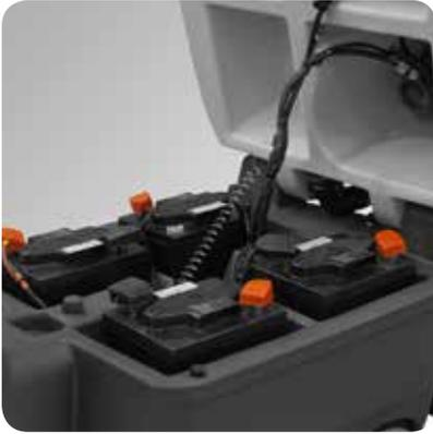
Der Reinigungsmitteltank dient als Batteriefach und ermöglicht die Unterbringung großer Batterien, die kontinuierlichen Arbeitseinsatz gewähren. Stoßsicherer und säurebeständiger Polyethylen-Tank mit großem Fassungsvermögen (110 l) erhöht die Produktivität durch Vermeidung von
