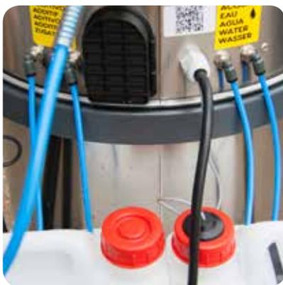
Auslassrohr zum schnellen Entleeren des gesammelten Schmutzwassers ohne den Kopf zu entfernen. Zweistufiger By-Pass-Unterdruckmotor mit Zyklonwirkung. Ausgestattet mit 3 Pumpen: Kessel, Reinigungsmittel und Wasser. Maximale Sicherheit dank der 2 Sicherheitsthermostate, 1 Druckschalter und 1 mechanischen Maximaldruckventil.
