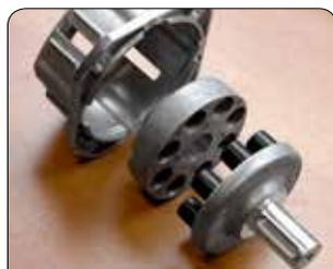
• Integrierte Elastikverbindung für besten Pumpenanschluss (außer Modell 1211).
