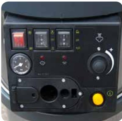
Neues einfaches und intuitives Bedienfeld, Schnellkupplungs-Dampfpistole, EIN/AUS-Hauptschalter mit Leuchte, Kessel-EIN/AUS-Schalter mit Leuchte, Dampf-Funktions-/Druckluft-Funktions-Wahlschalter, Wasser/Reinigungsmittel-Wahlschalter, Dampfdruck-Regler, Dampfereitschafts-Warnleuchte, Niedrig-Wasserstands-Anzeigelampe mit Summer, Dampfdruck- und Druckluft-Manometer.
