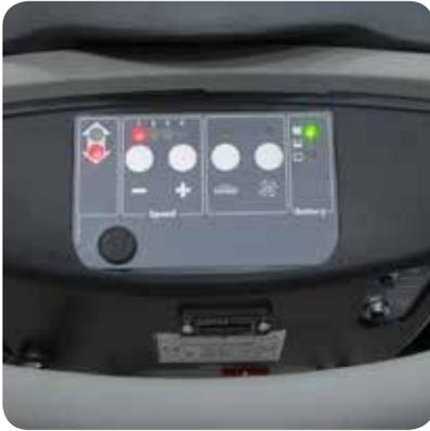
Benutzerfreundliches Bedienpult. Drehzahleinstellungs-Wählschalter. Allgemeiner EIN/AUS- und Zündschalter, Bürsten- und Vakuummotor-Schalter. Thermischer Schutzschalter zum Schutz von Vakuump- und Bürsten-Motor, Batterie-Ladezustandsanzeige,
