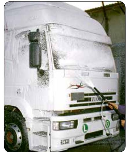
**Sprüher:** Druckluftlade-Sprühgeräte müssen an einen Luftkompressor angeschlossen werden, um den Tank aufzuladen und später die Zerstäubung des Erzeugnisses zu ermöglichen, ohne an den Luftkompressor angeschlossen zu sein. Sie arbeiten mit hohem Druck und verwenden daher aufnahmefähige Behälter aus Stahl oder Edelstahl, um eine größere Autonomie zu ermöglichen.
