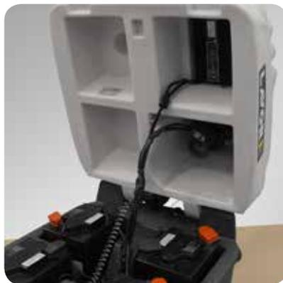
zeitverzögerter Abschaltung, Bürstenplatten-Anhebe/Absenk-Wahlschalter, Bürstenmotorschalter. Alle Motoren sind durch thermische Schutzschalter geschützt. Der Reinigungsmittel-tank dient als Batteriefach und ermöglicht die Unterbringung großer Batterien. Das Ladegerät und der Absaugmotor befinden sich im Auffangtank, die Unterbringung von Vakuum-Motor
