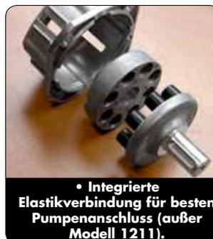
• Integrierte Elastikverbindung für besten Pumpenanschluss (außer Modell 1211).
