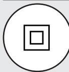
**Doppio isolamento\***: è una protezione supplementare dell'isolamento elettrico, questo apparecchio non richiede la connessione a terra.
